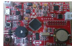
图4 智能测试前端电路实物图
