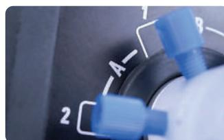
循环阀是一个6-口/2-位的微流控阀，允许在两种位置之间进行切换。应用领域有：稳定的单向流体循环和样品注入。
