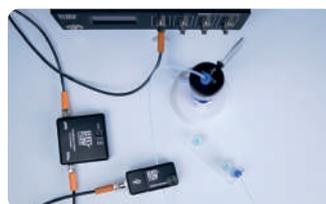
气泡探测器能够检测透明管道内是否存在液体，并向另一台仪器发出信号以采取相应措施：例如停止、等待一定时间、允许足够的流量充满管路或重置传感器。
