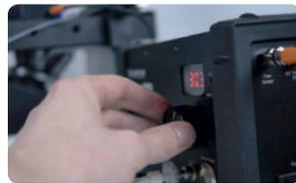
The AF1 是一款高性能的独立的压力和流量控制器. 它集成压力传感器和真空源, 有三种不同型号, 与Elevflow软件兼容。
