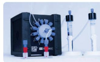
顺序注入阀是一个双向13口/12通的旋转阀，作为选择器可以将一个液体样品顺序注入到12条不同的管线中，或将12个液体样品顺序注入到一条管线中。
