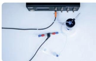
流通式压力传感器适用于气体或液体，采用标准的鲁尔接口。该传感器用于测量流过传感器的流体介质的压力。
