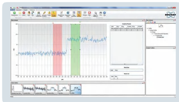
DektakXT 可以可靠测量厚度小于 10nm 的薄膜
