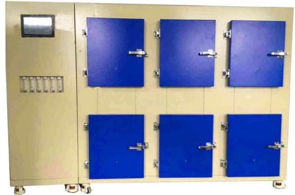
试件在  $23 \pm 1^\circ\text{C}$ ，相对湿度  $(50 \pm 5)\%$  条件下放置  $(15 \pm 2)$  d，试件之间距离至少 25mm，使客气在所有试件表面上自由循环，恒温恒湿室内空气置换率至少每小时 1 次，室内空气中甲醛质量浓度不能超过  $0.10\text{mg}/\text{m}^3$
