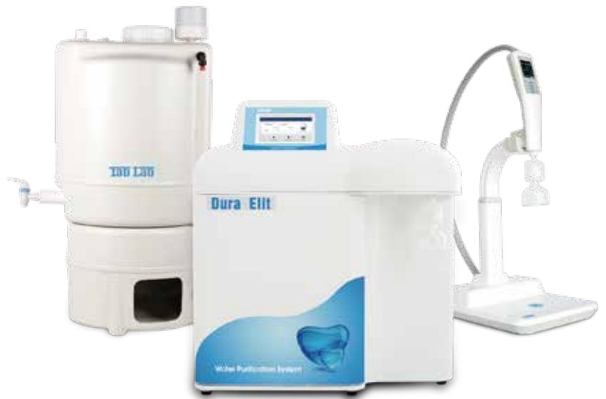
以城市自来水为水源，可方便快速的制造二级 RO 反渗透水、EDI 去离子水和 UP 超纯水，采用标准的双级反渗透系统及 Ionpure®EDI 技术及模块，可连续生产  $5\text{M}\Omega\cdot\text{cm}(25\text{C})$  以上且  $\text{TOC}<30\text{ppb}$  的 II 级纯水，及  $18.2\text{M}\Omega\cdot\text{cm}(25\text{C})$  的超纯水，标配 50 升 PE 纯水箱和 R-DIS 远程移动式独立取水器，完全满足实验室所有应用的用水需求。
