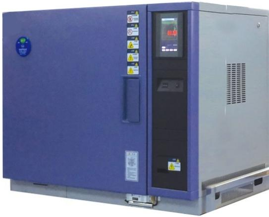
箱体外胆采用优质钢板喷塑处理，箱体内胆采用不锈钢镜面板（或拉丝板）氩弧焊接制作而成，耐高温硅胶迫紧。产品控制先进、温度均匀、安全可靠、系列齐全。广泛应用于航空、汽车、电工、电子、材料、能源、化工、医疗、制药等行业高温试验及热处理工艺。
