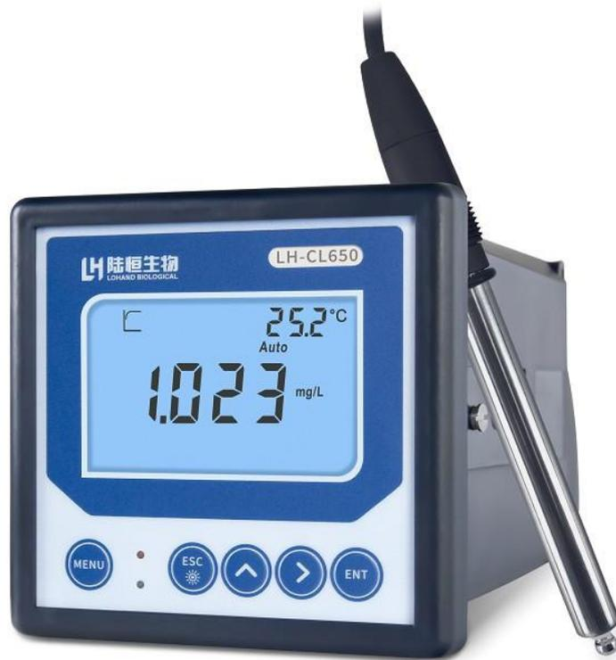
简介:该款控制器是基于微处理器设计开发的自动化仪器仪表，其设计的目的和应用是实现余氯值（游离氯）、次氯酸值（HClO）和温度值的连续和精确测量及控制。
