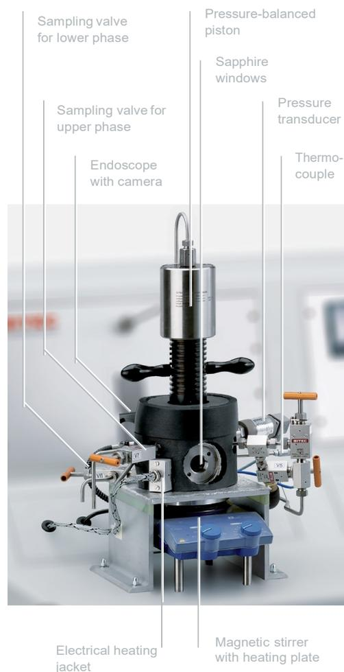
带压力平衡活塞的相平衡室
