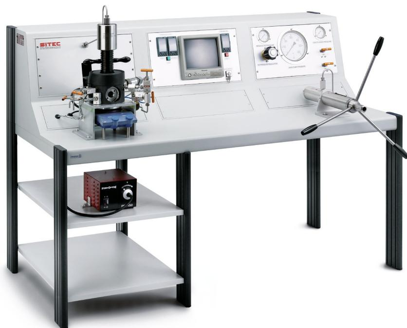
带可搅拌的光平衡室和压力平衡活塞的等压取样相平衡装置，该系统包括压力发生器、压力和温度控制系统、带内窥镜和冷光源的彩色摄像机，该装置在比利时一个医药公司运行。
