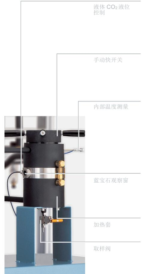
精密的终分离器，带可控的液体 CO<sub>2</sub> 液位以防止气溶胶产生
