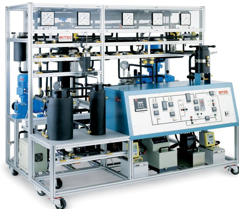
用于制药研究的最高压力为 500bar 的模块化 SFE 系统，该系统包含可选的组分分离系统、改性剂系统和 Coriolis 质量流量计
