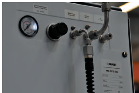
箱体侧面有 PTFE 清洗管路，进气管，主减压阀
