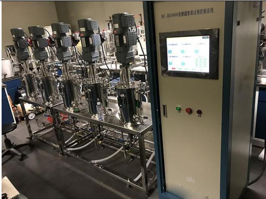
本产品普遍适用于科研院所以及企业的环境科学、环境工程实验室，是污泥厌氧发酵消化试验、餐厨垃圾发酵消化试验产甲烷沼气的理想工具。可以适用于厌氧发酵工艺参数的优化筛选以及对厌氧发酵消化过程各参数的在线监测及控制。
