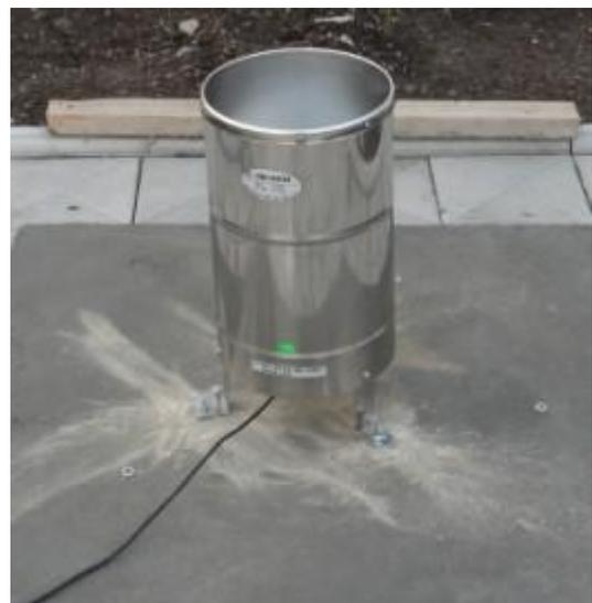
6465 雨量传感器为满足世界气象组织的规范，我们的翻斗式设计非常准确。用于气象降雨监控的每日和累积的降雨量以及降雨量。雨量传感器必须安装在平坦的表面上。雨收集器可以用用户标定为 0.2 mm。也可作为工厂校准的 0.2 mm 雨量桶。
