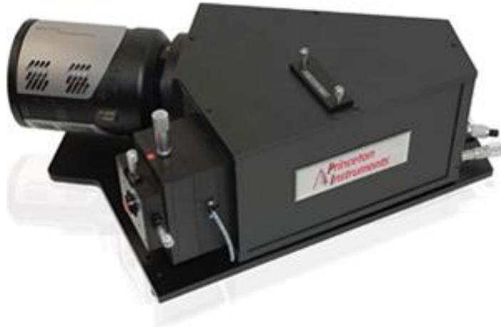
Acton LS-785 系列是棱镜型的光谱仪，光通量高，它具备  $f/2$  光学系统和抗反射镀膜棱镜，适合近红外波段的应用。 $f/2$  的入射孔径使得 LS-785 可以匹配数值孔径为 0.22 的光纤 (0.22 NA)，其光通量是普通  $f/4$  反射型谱仪的 4 倍。LS-785 的棱镜系统使用了普林斯顿仪器高性能的抗反射膜，光栅使用了定制的金膜提高反射率，这使其成为市面上光通量非常高的近红外光谱仪。LS-785 同样配置了光栅调节台，用户可以使用千分尺精准选择 750-1100nm 波段的频谱。
