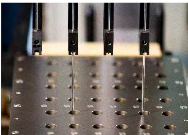
正在使用 4-通道移液工具进行液体加样的 **ISYNTH** 反应模块
