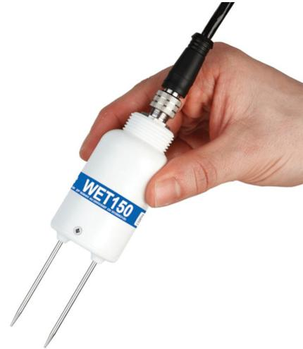
WET150 土壤水分温度盐分传感器的一个关键优势是它能够精确计算孔隙水电导率 (ECp)：即植物可用水的离子含量。是获得专利的传感器电子产品具有研究级的测量精度和卓越的盐度和温度稳定性，对关键控制和灌溉决策至关重要。当 WET150 埋入地下时，在根部区域进行温度测量（对补偿 EC 测量至关重要），以确保最高精度。
