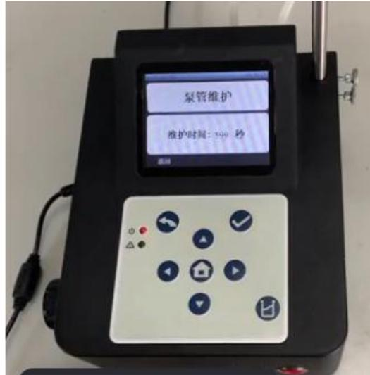
**产品描述：**TC-01 滴定分析仪，滴定分析仪，完美替代实验室酸、碱滴定管，酸、碱滴定都适用，快、慢速滴定自由选择；可直读毫升数，也可以自动计算结果；适用于所有滴定分析项目。
