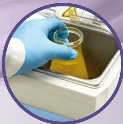
使用低液位保护帮助防止水浴损坏和过热。
