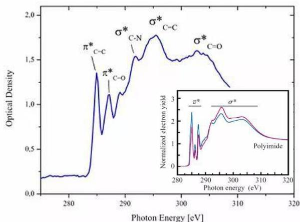
用桌面系统测试200nm聚酰亚胺薄膜的碳K边NEXAFS光谱（60发脉冲平均值）。插图为桌面系统测试结果与同步辐射的比较。
