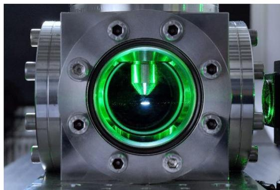
XUV光源使用高度可靠的激光等离子体产生。能量范围200-1200eV。重复频率25Hz。
