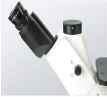
两档转换式观察筒：100%观察；20%观察，同时80%摄影
