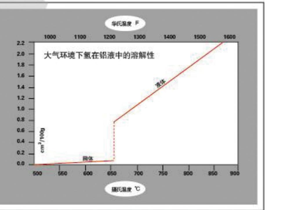
**HYSCAN II** 采用快速降气压技术测定氢气含量，将100克熔融铝液注入一个不锈钢的样品池，使用高速真空泵在几秒钟内将样品池的压力抽至绝对压力10 Pa (即：0.0001个大气压)。然后，样品池和真空系统与真空泵隔离，样品开始固化。
