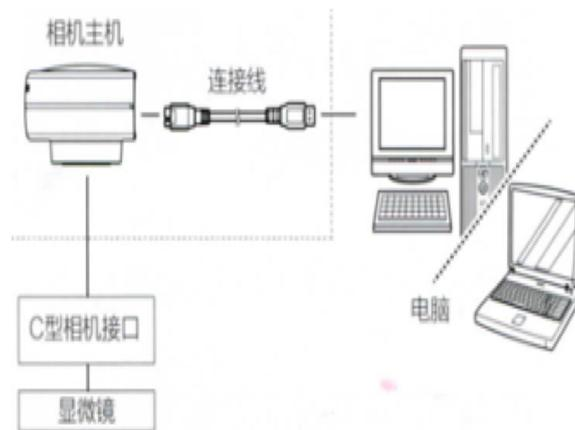
虽然NP17功能丰富，但是它依然可以即插即用，无需外接电源；支持标准C-MOUNT镜头及各类定制镜头，坚固耐用的铝合金外壳。安装使用操作简单，全新的USB3.0接口，可达30帧每秒的处理速度。不需要额外的采集设备，即插即用，即可获得实时的无压缩数码图象，
