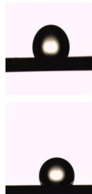
金属丝表面镀膜后接触角测量
