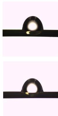
高分子材料单丝表面接触角测量
