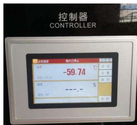
6.5 屏幕显示: 设定温湿度; 实测温湿度; 加热、加湿、时间、温湿度曲线等工作状态以及各种报警指示。
