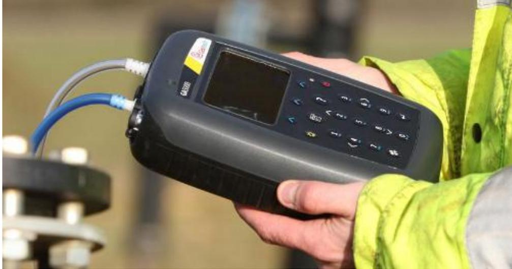
便携式沼气分析仪主要应用于生物质厌氧发酵项目的沼气监测工作。BM 5K(Biogas 5000)操作简单、校准方便，比原款式更小、更轻、精度更 GAO
