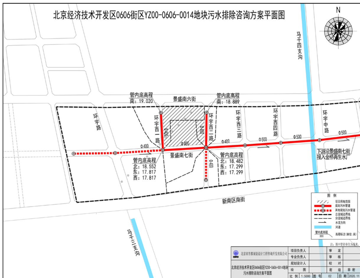
图 7.2.2-2 本工程周边市政污水管网规划图
