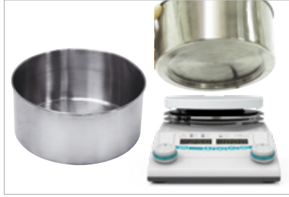
油浴锅 顶部凹凸式结构，可防止滑动。
