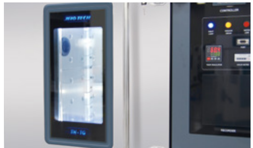
钢化玻璃窗，带线加热丝和LED灯
