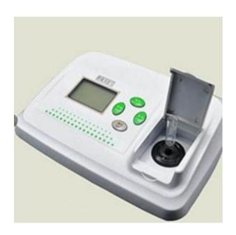
细菌浊度仪主要用于测定待鉴菌株悬液中细菌浓度。本仪器采用(BaSO4)麦氏浊度标准溶液进行标定,采用 MCF(McFarland)麦氏浊度单位。直接显示麦氏单位浊度值。适用于医疗卫生单位、生物制品、检疫机构及科研机构的细菌菌液浓度测定。
