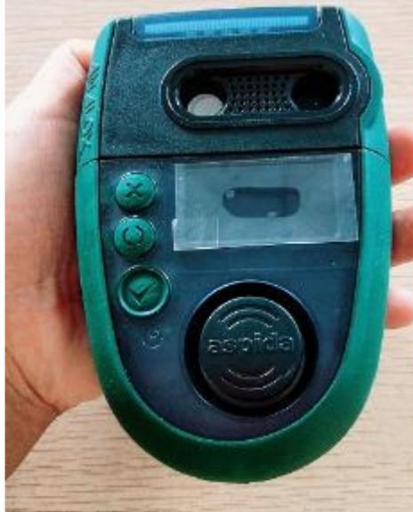
ASP BB 02 Y 11 01 食用菌生物科技推荐英国安娜劳克斯 aspida 二氧化碳检测仪
