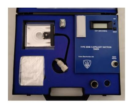
自 20 世纪 70 年代以来,毛细管抽吸时间被用作表征污泥可过滤性和可条件性的检测方法。 污泥可过滤性是脱水设备(包括:干化床、带式压滤机、真空过滤机、压滤机和离心机)的 性能。
