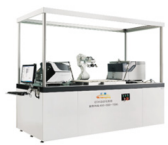
智能EDX重金属测试系统
