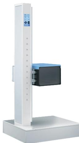
Gasboard-6100采用双摄像头结构和紧密光学系统进行寻光定位和测量分析,结合数字图像处理和运动控制技术组成智能化测量系统。实现对前照灯远光,近光各项参数的全自动快速准确测量。满足车辆卤素灯、氙气灯、LED及各种灯型的检测,适用于机动车安全技术/综合性能联网检测、汽车制造厂总装(质保)检测线和机动车维修部门的维修保养检测。仪器满足GB 7528-2017《机动车运行安全技术条件》及GB 38900-2020《机动车安全技术检验项目和方法》等相关标准要求。
