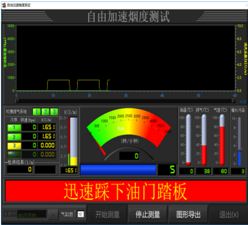
图 2 自由加速烟度测试
