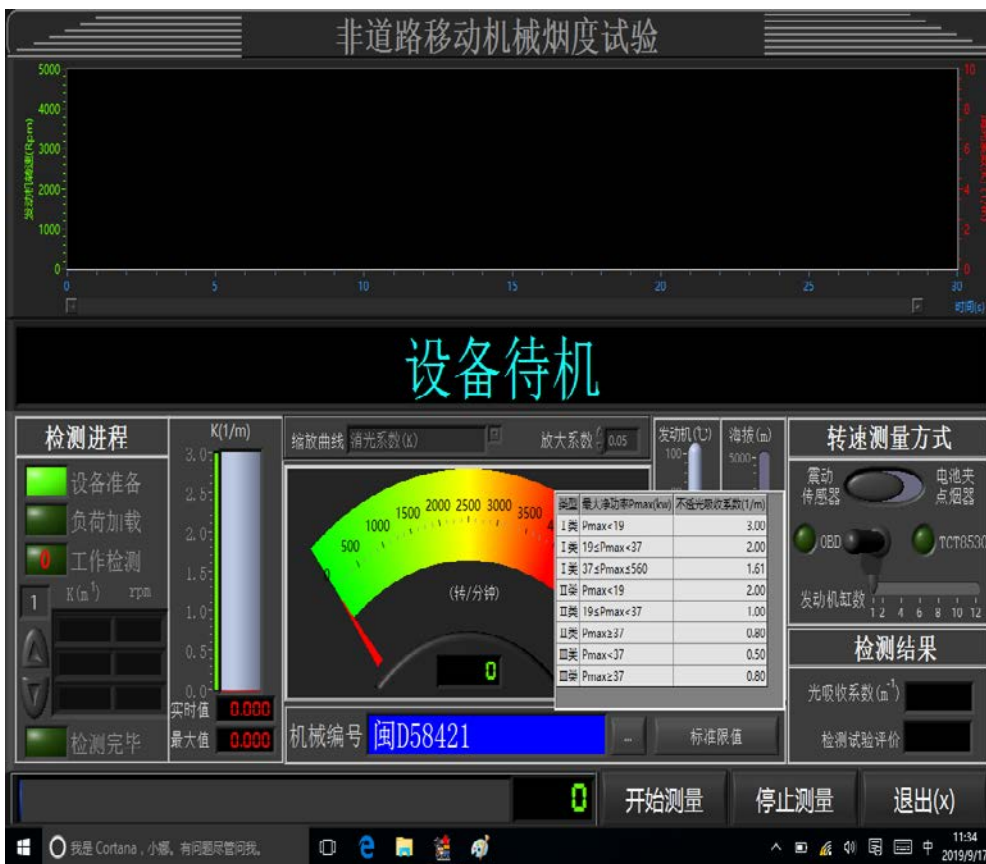
图 1 非道路移动机械自由加载烟度测试
