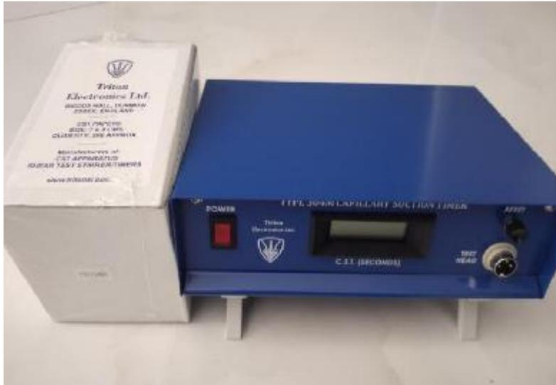
自 20 世纪 70 年代以来，毛细管抽吸时间被用作表征污泥可过滤性和可条件性的检测方法。污泥可过滤性是脱水设备（包括：干化床、带式压滤机、真空过滤机、压滤机和离心机）的性能。
