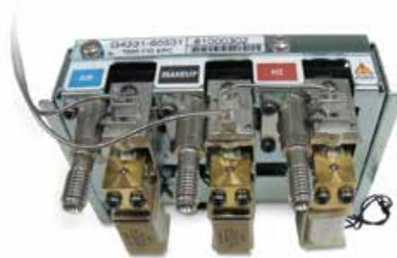
7820A 气相色谱系统的电子气路控制 (EPC) 模块
