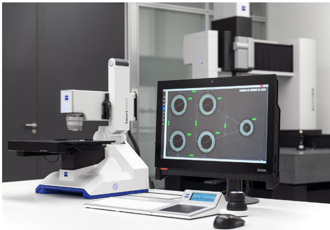
在测量实验室中应用 Sartzoom 5。蔡司 NEO pixel 软件对组件的微观特征自动进行测量。
