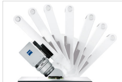
Smartzoom 的 0.5x、1.6x 及 5x 物镜均具有足够长的工作距离，可在 -45 到 +45 度的倾斜范围内倾斜摇臂，而不存在致使物镜边缘与大型组件（例如 PCB）发生碰撞的风险。
