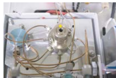
八通阀设计，45度旋转，马达驱动
