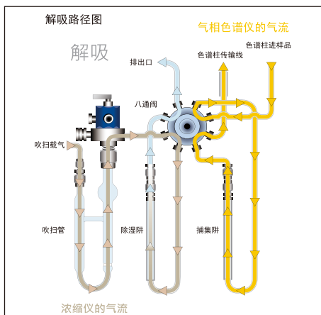
八通阀将解吸路径从GC中分离出来，与湿度控制分离，降低了捕集阱和GC之间的样品路径长度
