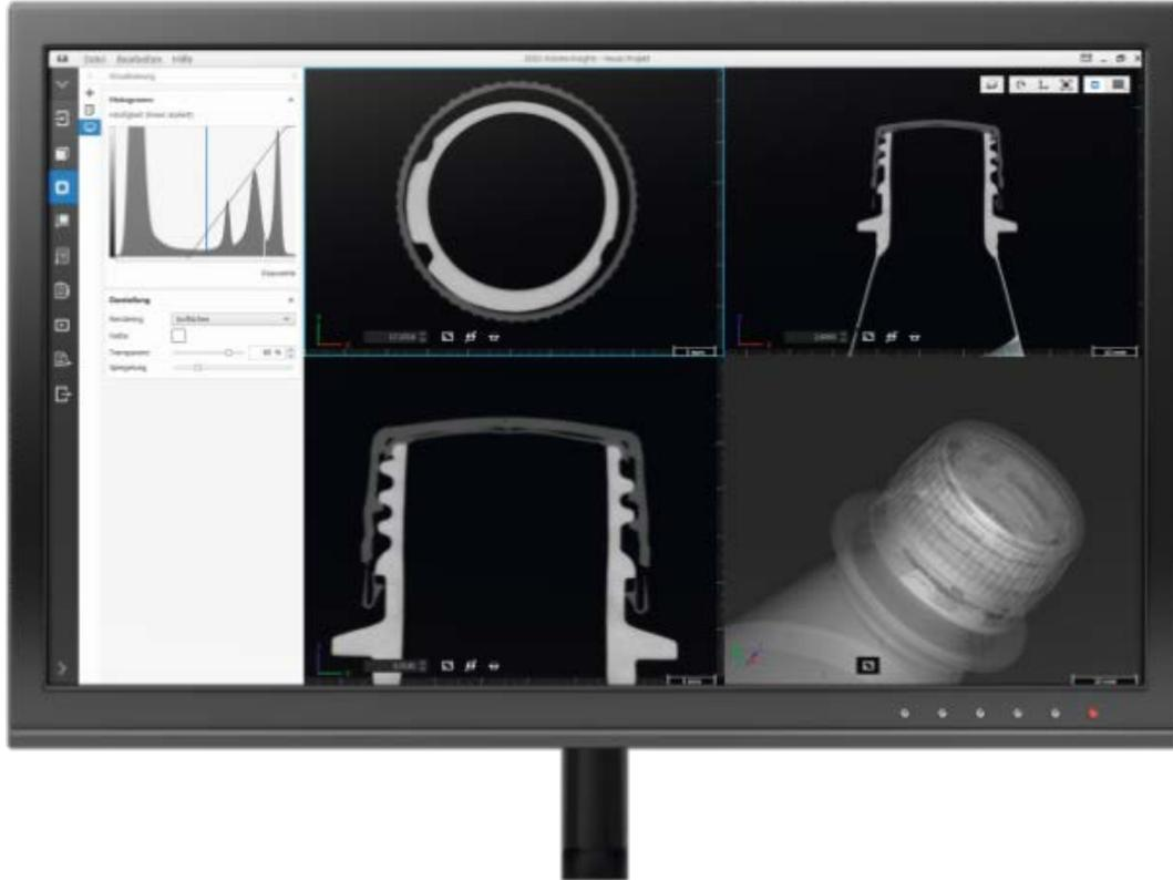
脱模的首件是整个工艺及模具本身测试的关键。首件检验 (FAI) 是一个细致的测量过程，用于测量试验件的形状和大小是否与原 CAD 模型一致。该过程涉及包括 CMM 和视觉系统在内的多个测量设备，在检查多腔模具制品的几何形状时，可能需要数十甚至数百小时的时间。
