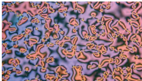
液晶, 混合排列晶胞中的缺陷结构。交叉偏振光镜, 放大5倍。
