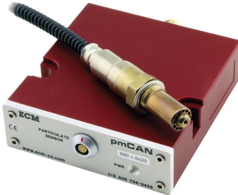
美国ECM公司排气微粒模块pmCAN彻底改变了柴油机和火花点火式发动机排气中颗粒物测量，该系统采用了火花塞大小的微粒传感器，只需将其拧入发动机的排气管即可，无要气泵，无需压缩空气，无需丁醇，无需高功率要求，无需笨重仪器，所有这些都是其他微粒测量系统成本的一部分。
