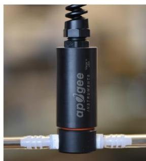
泵吸式探头安装图
