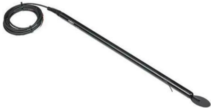
LT-1T叶面温度传感器是一个微型接触式探头，测量植物叶面的-概温度。传感器上比较轻的不锈钢导线夹包住一个高精密的玻璃包装热敏电阻，热敏电阻的直径为毫米级。探头的小尺寸和特殊设计对叶面的自然温度几乎不会产生任何干扰。
