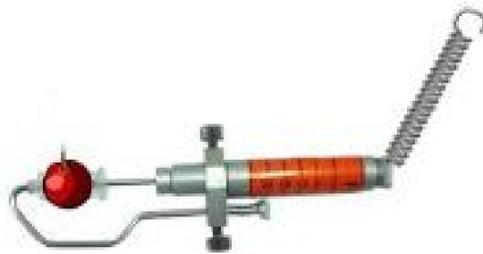
FI-ST / FI-MT / FI-LT 果实生长传感器这是一个系列位移传感器，主要用于记录完全圆形的果实的生长尺寸和生长速度，在7 -160毫米范围内，通过三个直径变化测量。移动臂原始设计为平行四边形，提供牢固的笔直的传感器位置，用于果实研究。
