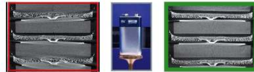
在电池中使用螺旋形扫描以消除锥束伪影 (左)
