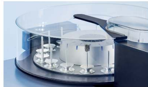
最多支持 16 个样品, 最大直径为 45 mm
