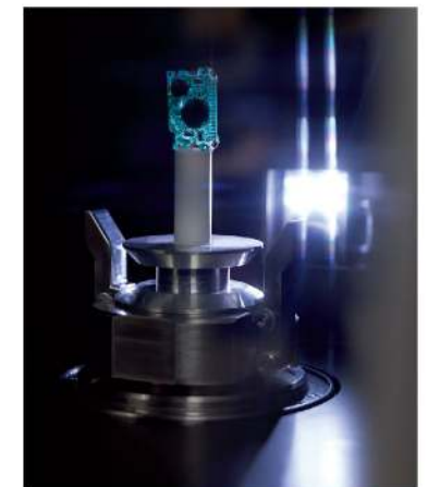
最高分辨率依赖于集成微定位样品台和手动载入样品
