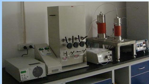
**夹带剂泵:** 用于在线或离线向萃取釜内添加一定量的有机溶剂, 用以改善二氧化碳萃取剂的极性, 提高对极性目标物的选择性。主要技术指标为:
