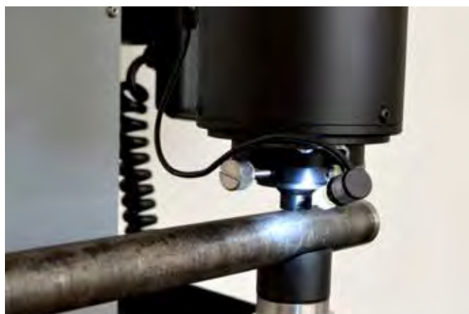
V 型试台和夹紧装置 编号: 900030797 和 W2100CL
