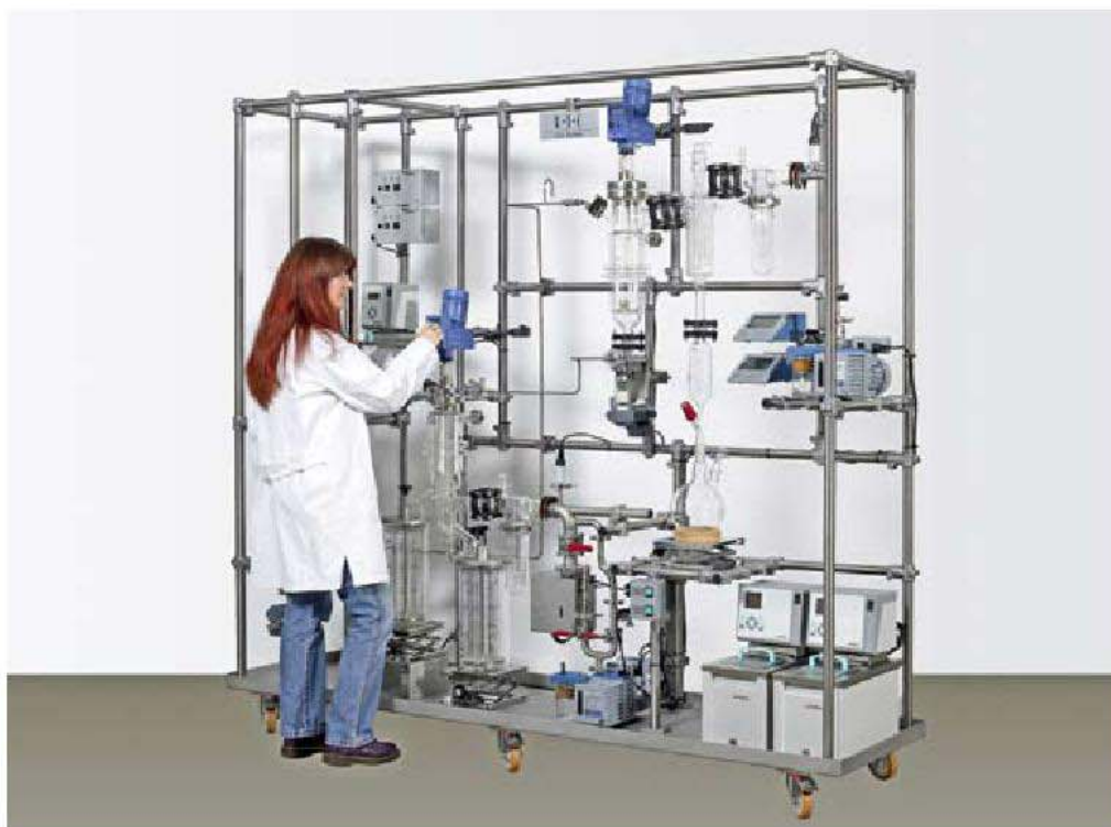
两级KDL5实验室分子蒸馏装置带有一级薄膜与一级短程蒸馏装置
