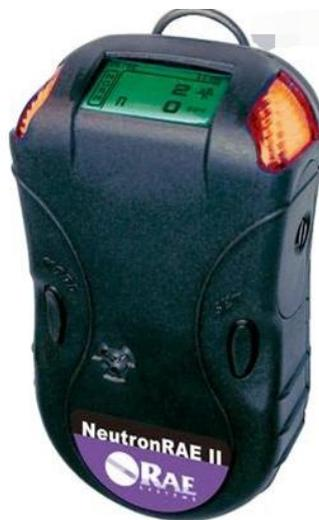
PRM-3021 $\chi$ 、 $\gamma$ 、中子射线快速检测仪是美国华瑞公司生产的一款多功能 $\chi$ 、 $\gamma$ 、中子辐射检测仪，该仪器采用碘化铯和碘化锂闪烁晶体双探测仪，仪器灵敏度高，响应速度快，测量稳定。便于携带，仪器集成度高，软件功能强大，外壳采用防滑材料设计，抗跌性能好。
