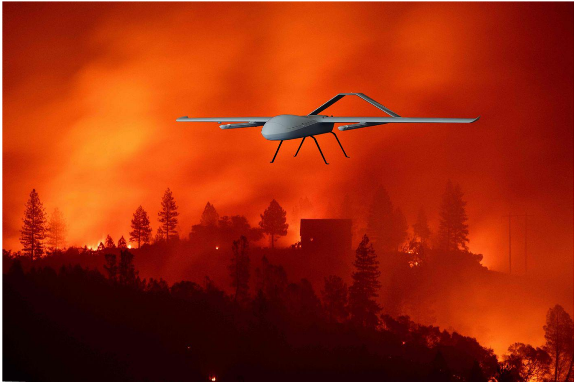
图 12 GA900FX 采用的固定翼油电混合垂直起降无人机，飞行时间可长达 8 小时
