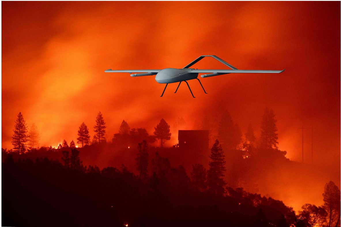
图 1 GA900FX 采用的固定翼油电混合垂直起降无人机，飞行时间可长达 8 小时
