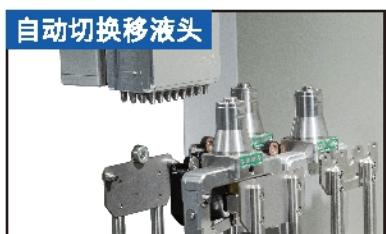
采用空气注射泵原理,移液精度可靠又高效;移液头Barrel采用高硬度、轻质合金材料及表面耐磨涂层,长期使用不易损坏,使用寿命更长,同时现场更换便捷且操作简单。配套定制Tips,严格QC,确保吸排液可靠稳定、无漏液、无残留。
