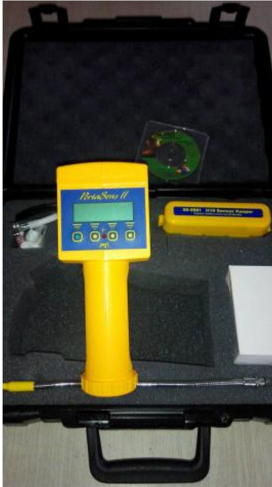
PortaSens III 气体检测仪配有一个带有海绵内填料的便携箱，方便贮存和运输。可装一个外接用电池，一个传感器储存盒（可装4个即插即用传感器，标准配置仅包括一个传感器储存盒）。
