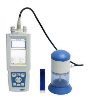
SJB-802 型重金属快速检测仪,采用阳极溶出伏安法,既支持丝网印刷电极,又支持三电极测量,可应用于铅、镉、铜、砷、汞、锌、硒、锰、镍、铬等重金属的检测。该仪器拥有与原子吸收等大型仪器相近的检出限和检测灵敏度,设计新颖,体积小巧,操作简单,智能化程度高,误差小等特点。
